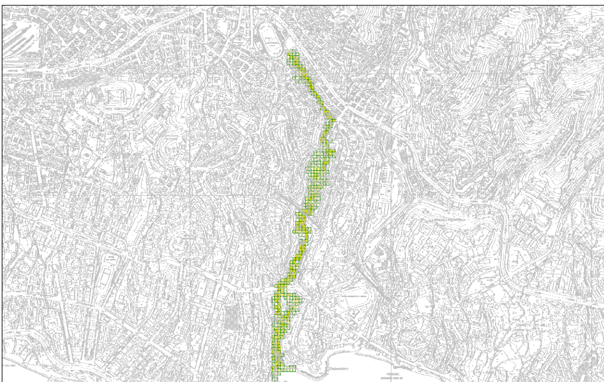
Figura 2: modellazione 2D della diffusione dell’esondazione per Tr=200 anni
