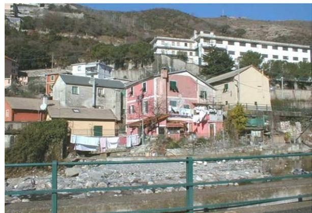
*Fig.2.6.1.2.3 - Sponda destra a valle del ponte 71.5: i piani abitati sono a circa 2 m dal fondo alveo, non protetti da argini.*
