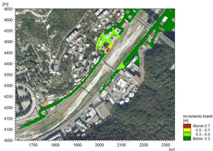
Figura 5.28 Ponte Bezzecca, TR=200 anni – Incremento di tiranti della configurazione di occlusione rispetto allo stato indisturbato.
