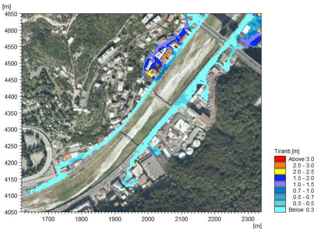
Figura 5.23 Ponte Bezzecca con occlusioni, TR=200 anni – Tiranti idrici massimi.
