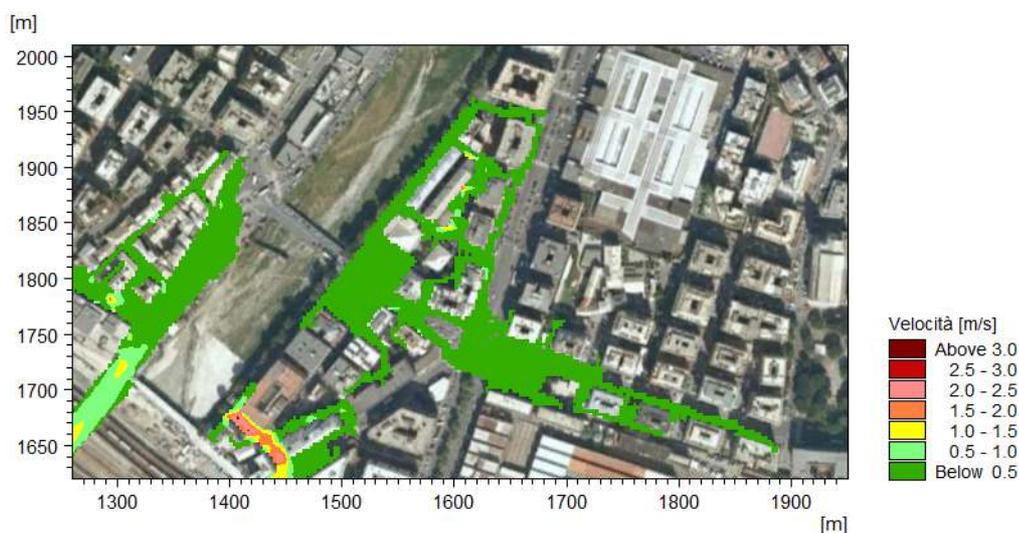
Figura 5.47 Ponte Castelfidardo con occlusioni, TR=50 anni – Velocità massime.
