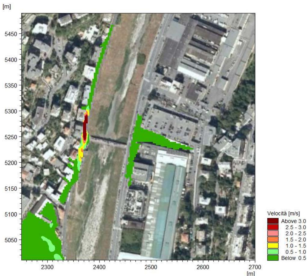
Figura 5.12 Ponte Guglielmetti con occlusione, TR=200 anni – Velocità massime.
