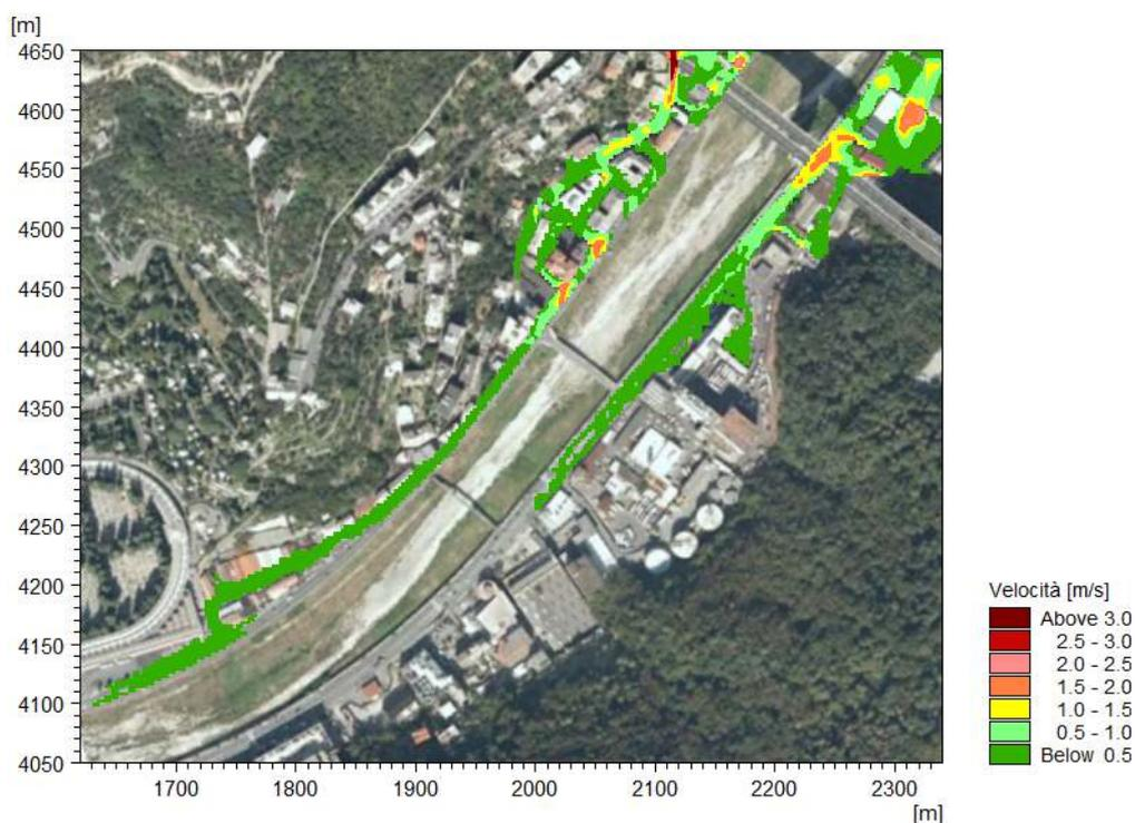
Figura 5.29 Ponte Bezzecca senza occlusioni, TR=200 anni – Velocità massime.
