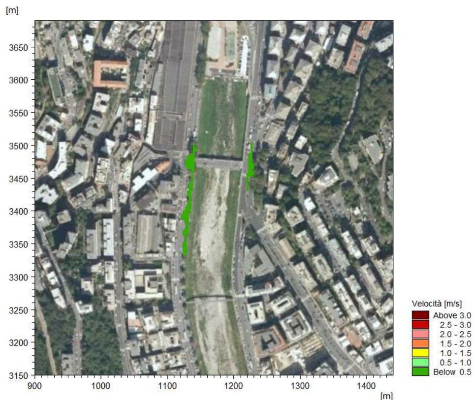
Figura 5.33 Ponte Campanella con occlusioni, TR=50 anni – Velocità massime.
