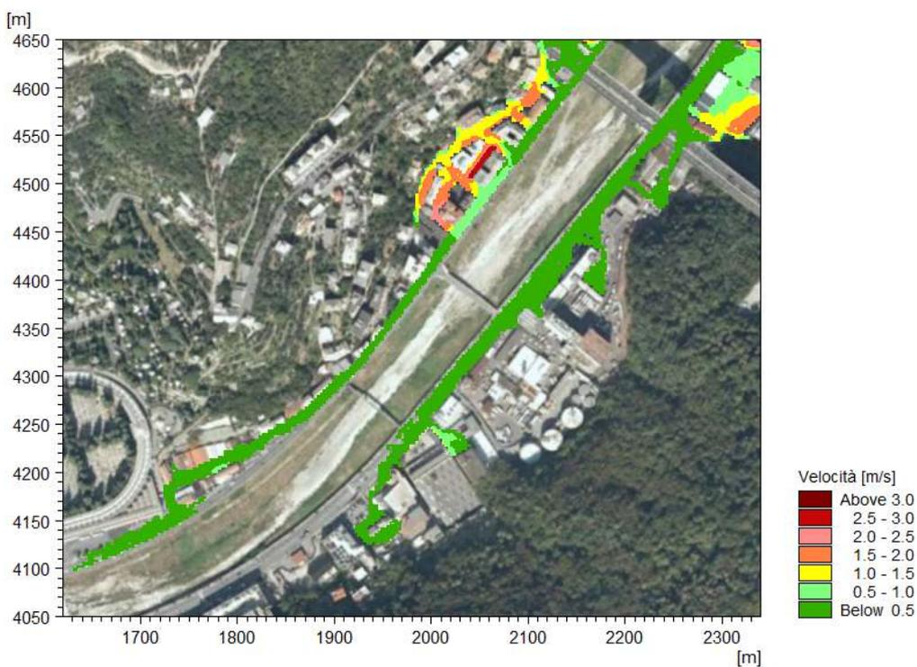
Figura 5.30 Ponte Bezzecca con occlusioni, TR=200 anni – Velocità massime.
