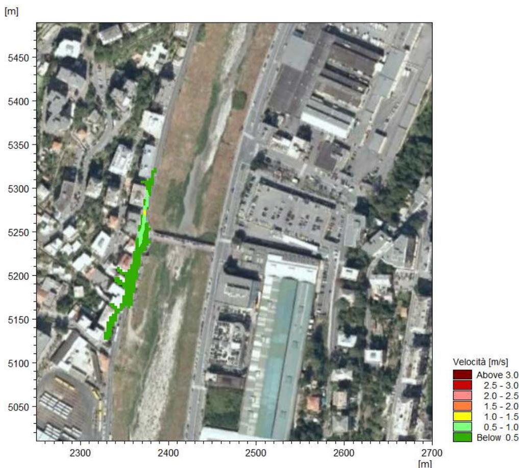
Figura 5.8 Ponte Guglielmetti con occlusione, TR=50 anni – Velocità massime.
