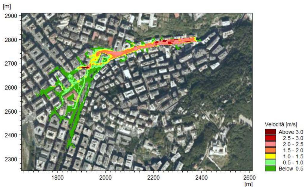
Figura 5.54 Copertura terminale del Rio Fereggiano con occlusioni, TR=50 anni – Velocità massime.
