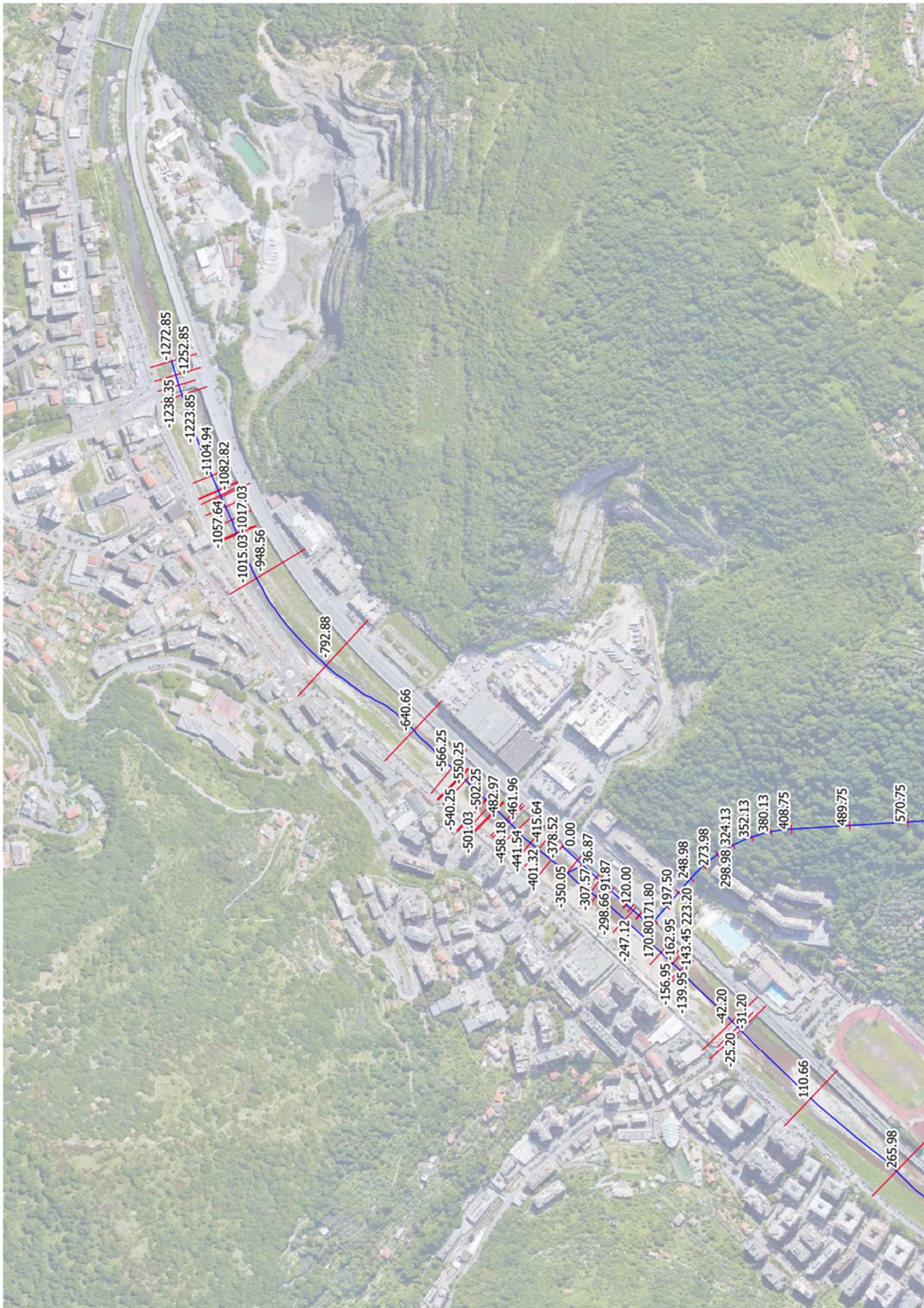
Figura 45 – Localizzazione delle sezioni inserite nel modello MIKE11 allestito per il torrente Bisagno, tratto 1 (procedendo da monte verso valle).
