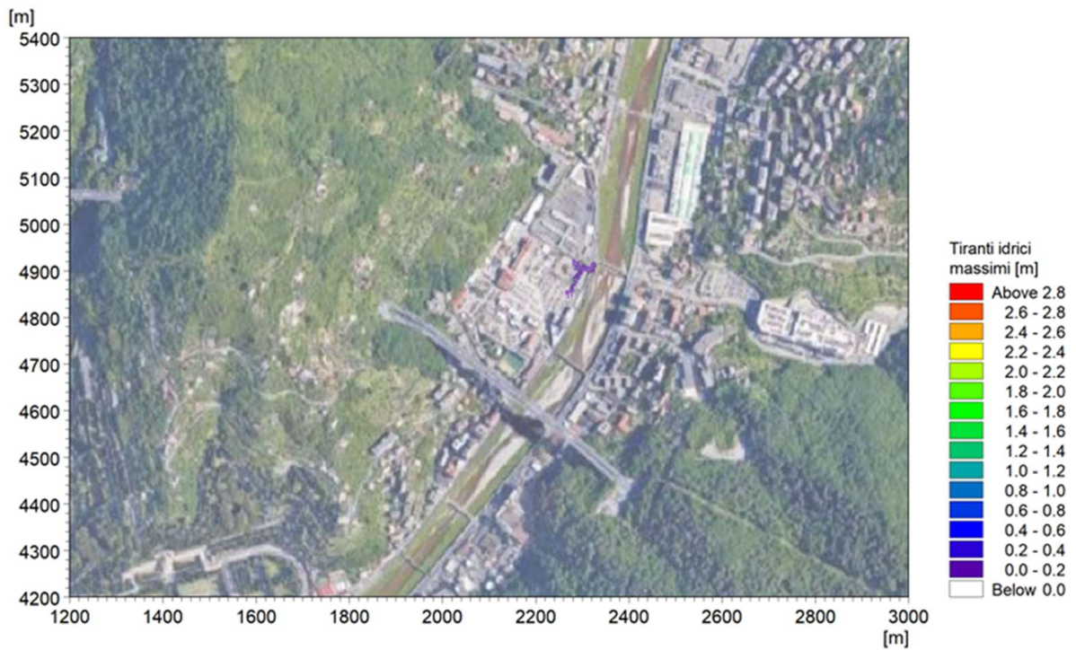
Figura 83 - Distribuzione delle massime altezze d'acqua rispetto al piano campagna per l'evento di piena con TR=50 anni, SIM1D.
