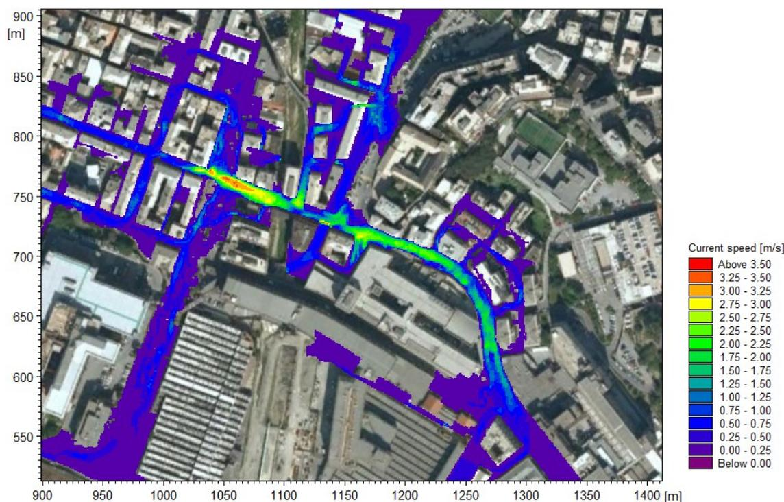
Figura 4.22 Particolare delle velocità di deflusso delle esondazioni del modello 2D in Via Giotto
