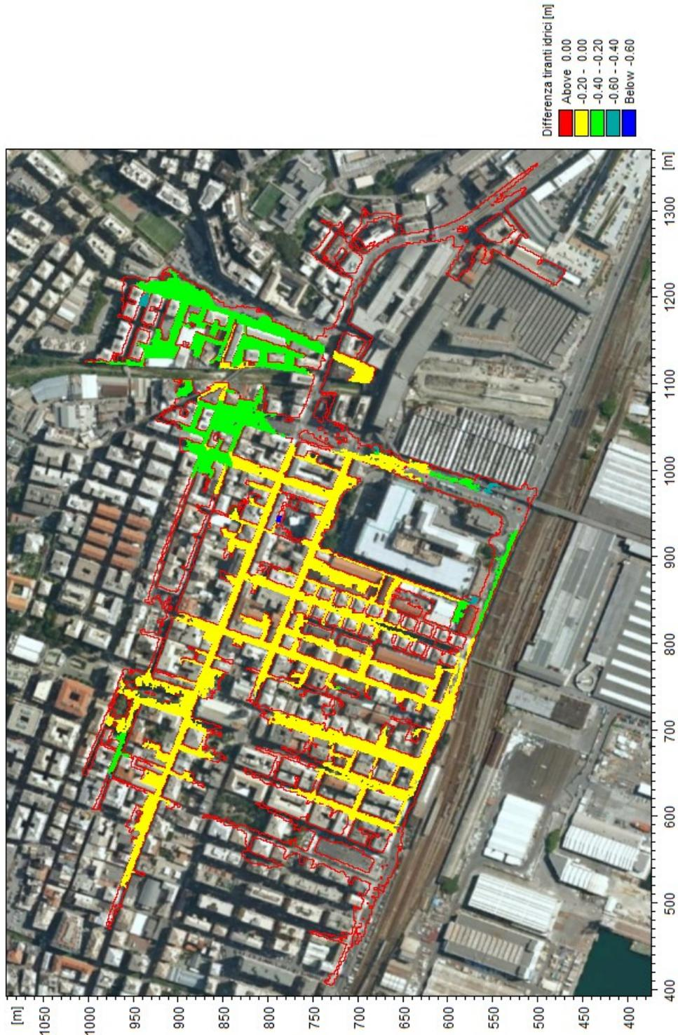
Figura 6.4 Confronto tra I tiranti idrici di allagamento delle due configurazioni di progetto illustrante l'abbassamento di tirante idrico generato dalla nuova configurazione di progetto; in rosso è riportata la perimetrazione degli allagamenti nella configurazione di progetto con il ponte attuale.
