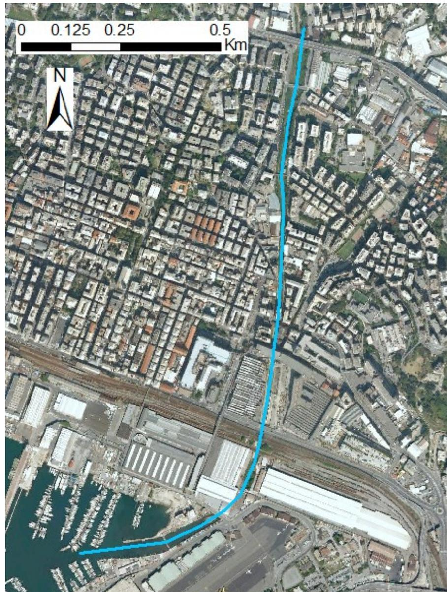
Figura 4.2 Tratto del Torrente Chiaravagna schematizzato con approccio 1D.
