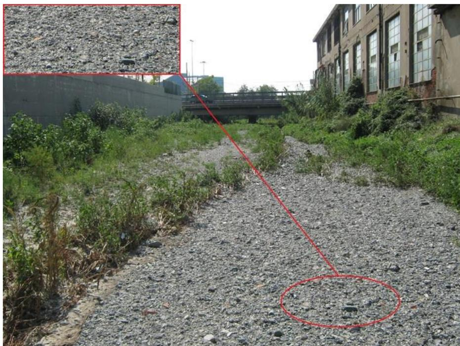
Figura 4.79 Torrente Chiaravagna: granulometria del fondo alveo in corrispondenza del tratto compreso tra le sezioni CHI11-CHI08 del Piano di Bacino (sottotratto granulometrico intermedio)
