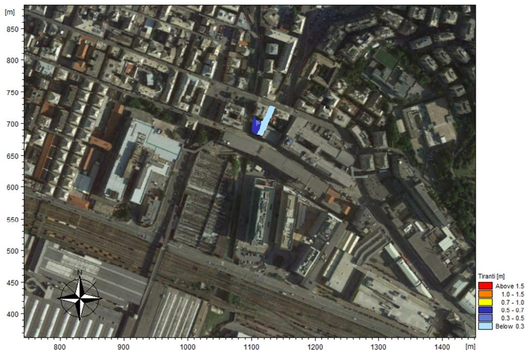
Figura 4.6 Torrente Chiaravagna – Massimi tiranti degli allagamenti con tempo di ritorno 200 anni nella configurazione di progetto senza parzializzazione delle sezioni.
