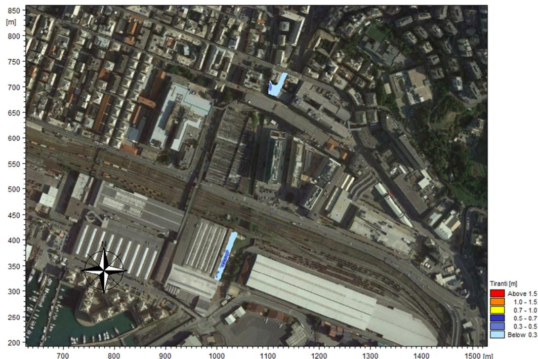
Figura 4.10 Torrente Chiaravagna – Massimi tiranti degli allagamenti con tempo di ritorno 200 anni nella configurazione di lungo periodo.
