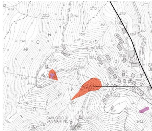
CARUGGIO SAN MARTINO, IN ROCCIA E COLTRE, INTERROTTA LA S.C., IN FASE DI REALIZZAZIONE INTERVENTO DI SISTEMAZIONE (PALI, ECC.). COMUNE DI SAN COLOMBANO CERTENOLI
