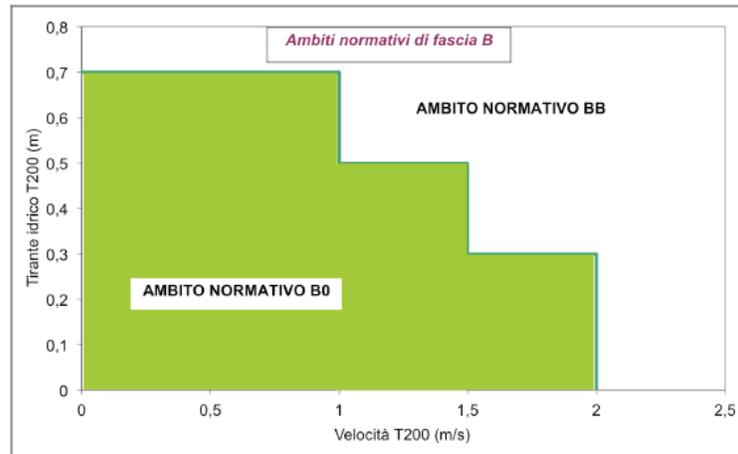
Figura 1. Soglie di pericolosità relativa in termini di tirante idrico locale  $h_{200}$  condizionato alla velocità locale della corrente  $v_{200}$  ai fini della definizione degli ambiti normativi in fascia B
