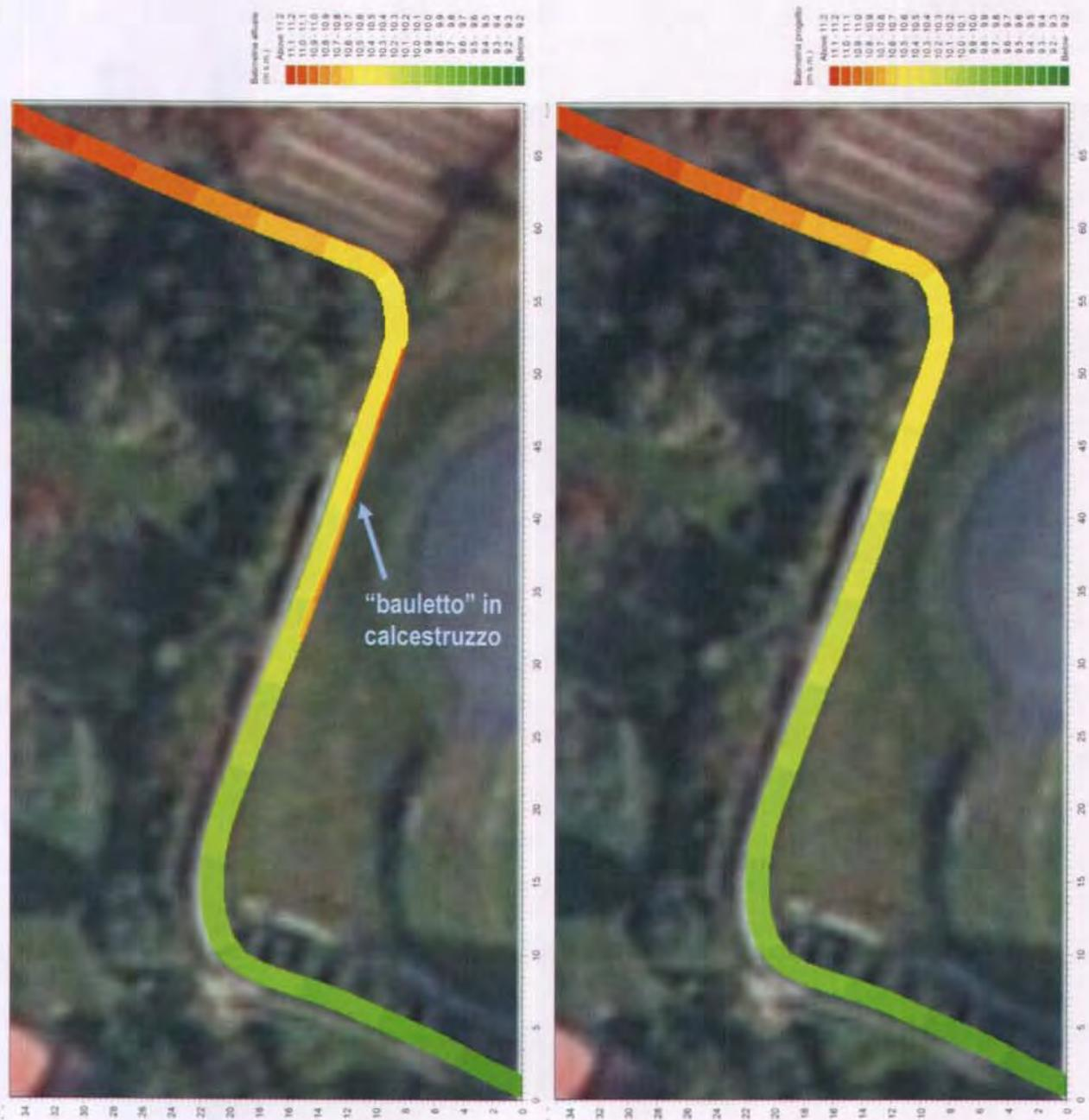
Figura 36 – Batimetria 2D di stato attuale (sx) e progetto (dx) del rio Rattaconigli, con griglia 0,05x0,05 m.
