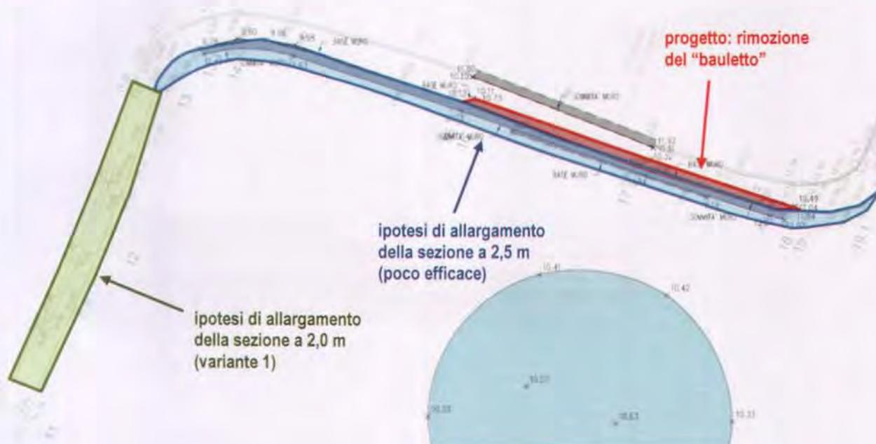
Figura 43 – Schema dei possibili interventi analizzati per la sistemazione del tratto di valle del rio.
