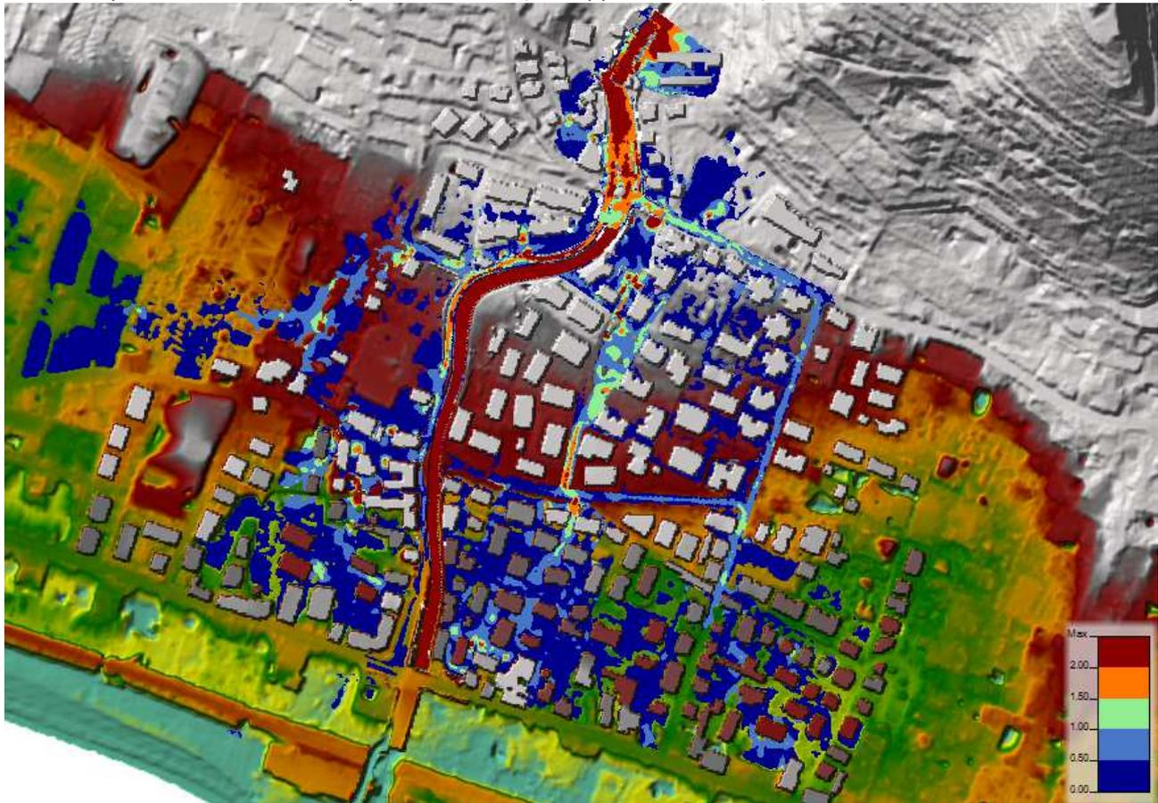
Anche in termini di velocità si riscontrano moduli superiori a 1.50 m/s soltanto in corrispondenza dello scatolare e all'imbocco di via Pasteur e via Bigarella; valori compresi tra 1.00 m/s e 1.5 m/s sono presenti lungo le vie Pasteur e Bigarella, dove il modello caratterizza una potenziale concentrazione dei deflussi; a valle di via Aldo Moro anche per quanto riguarda le velocità valgono le considerazioni precedenti, e cioè che i valori del modulo velocità sono prossimi allo zero.
