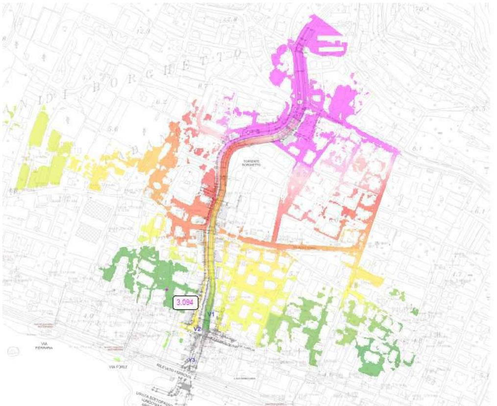
Infine nel seguito la durata dell'inondazione per TR200 anni in ore da inizio evento sino a fine simulazione (4 ore in tot)
