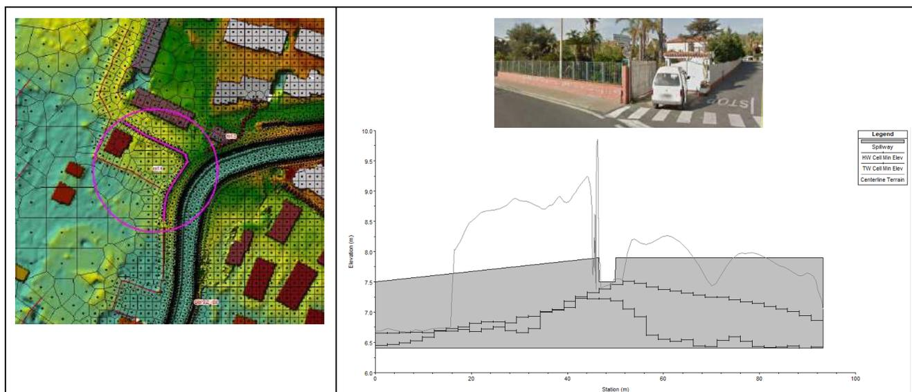
Un esempio di internal connection tipo “weir” con muretto di circa 1 m e cancellata con potenziale ingresso nella proprietà.
