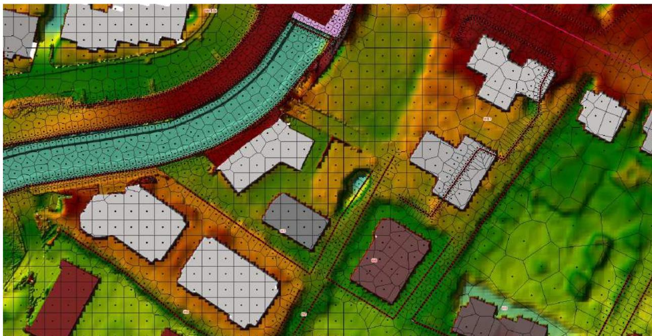
Complessivamente sono state implementate nella mesh 23 “break lines” e 28 “internal connection” differenti.
