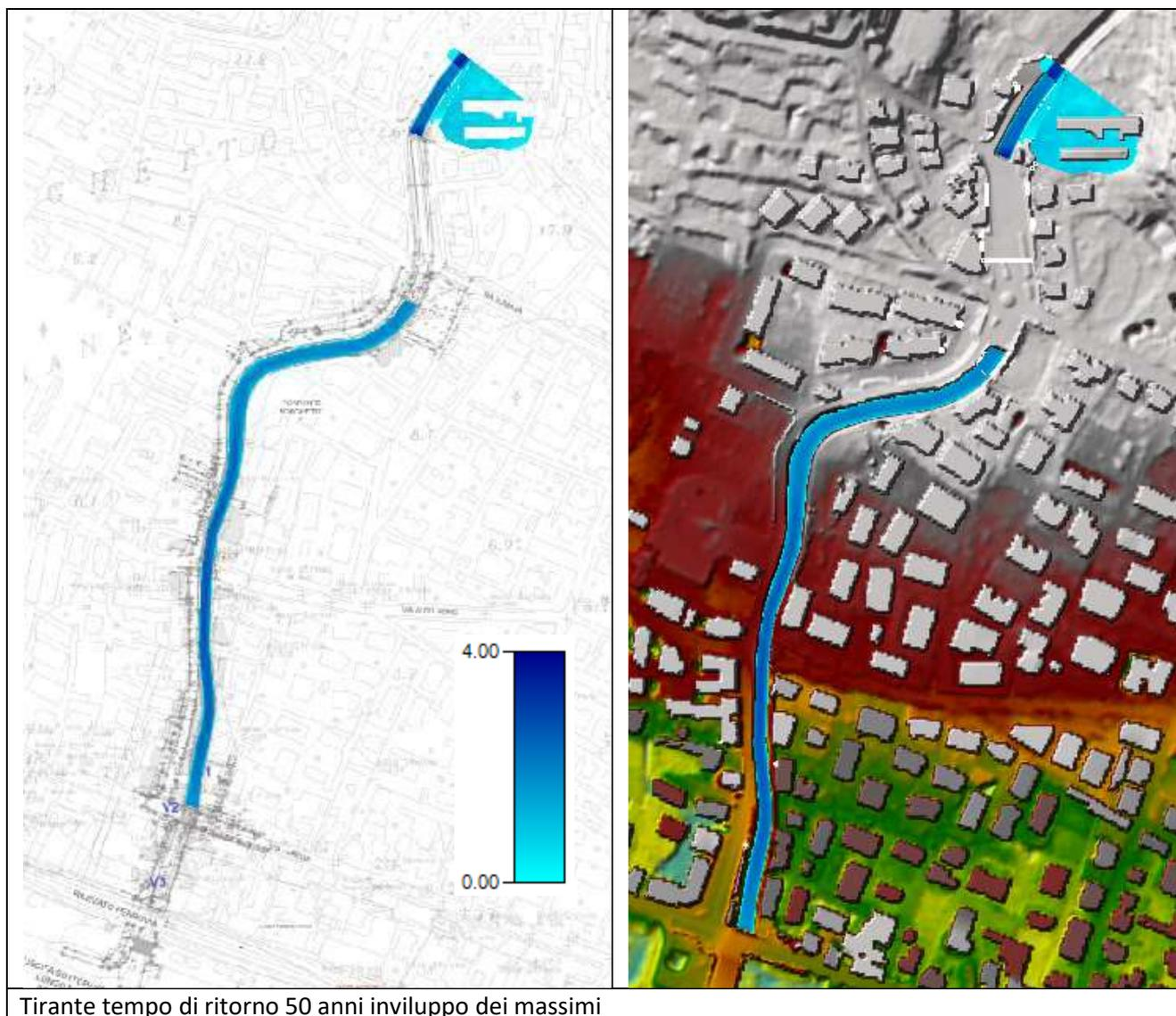
come si osserva per TR 50 la portata è contenuta sempre in alveo con esclusione della zona a monte dell'imbocco scatolare ove si verifica esondazione in sinistra.
