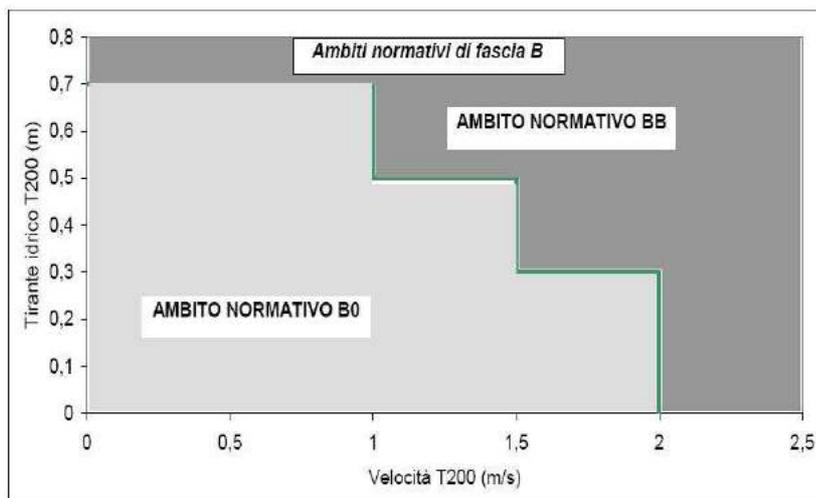
Utilizzando funzionalità GIS applicate ai risultati della simulazione è stato calcolato il prodotto tra il tirante e la velocità; tale prodotto rispetta la precedente indicazione quando risulta inferiore a 0.5-0,7 m<sup>2</sup>/s.
