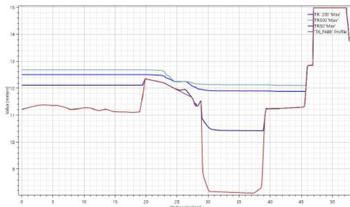
Sezione del T. Borghetto poco a monte dell'imbocco scatolare con esondazione su via Pasteur in destra. La figura consente di valutare in circa 60-70 cm il tirante atteso su via Pasteur in corrispondenza dell'imbocco dello scatolare. Inoltre si vede l'effetto di rientro dalla zona delle serre in sinistra per effetto dell'edificio presente a valle e delle baracche lungo sponda.
