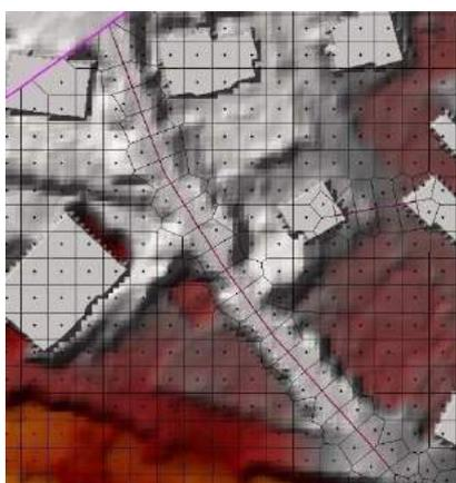
il modello Hec Ras 5.03 consente inoltre di introdurre all'interno di un dominio totalmente bidimensionale ulteriori particolari elementi numerici chiamati "internal connection" che consistono appunto in connessioni particolari che avvengono tra celle attigue all'interno del dominio. In questo modo è possibile imporre che tra due celle sia presente per esempio un muro, un muro con paratoie oppure un muro con collegamenti di tipo "culvert" ovvero canalizzazioni.
