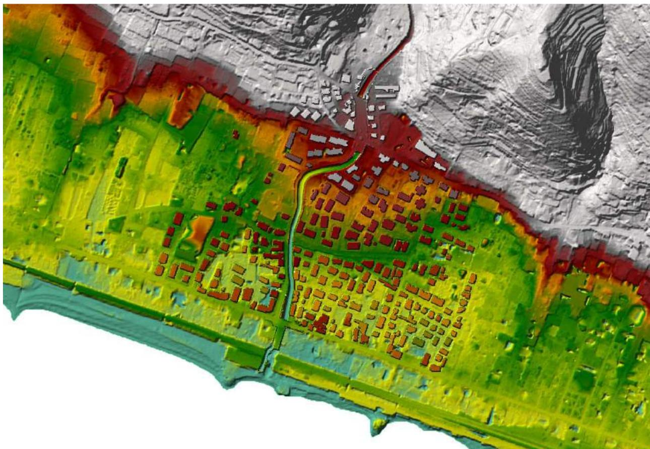
L'immagine evidenzia come in prossimità del torrente ed in particolare in corrispondenza dell'imbocco di monte dello scatolare e per tutto il tratto dove si sviluppa la principale esondazione la precisione topografica introdotta nel modello sia molto elevata e completa dell'edificato principale. Nel seguito alcuni dettagli di particolare rilevanza della geometria adottata:
