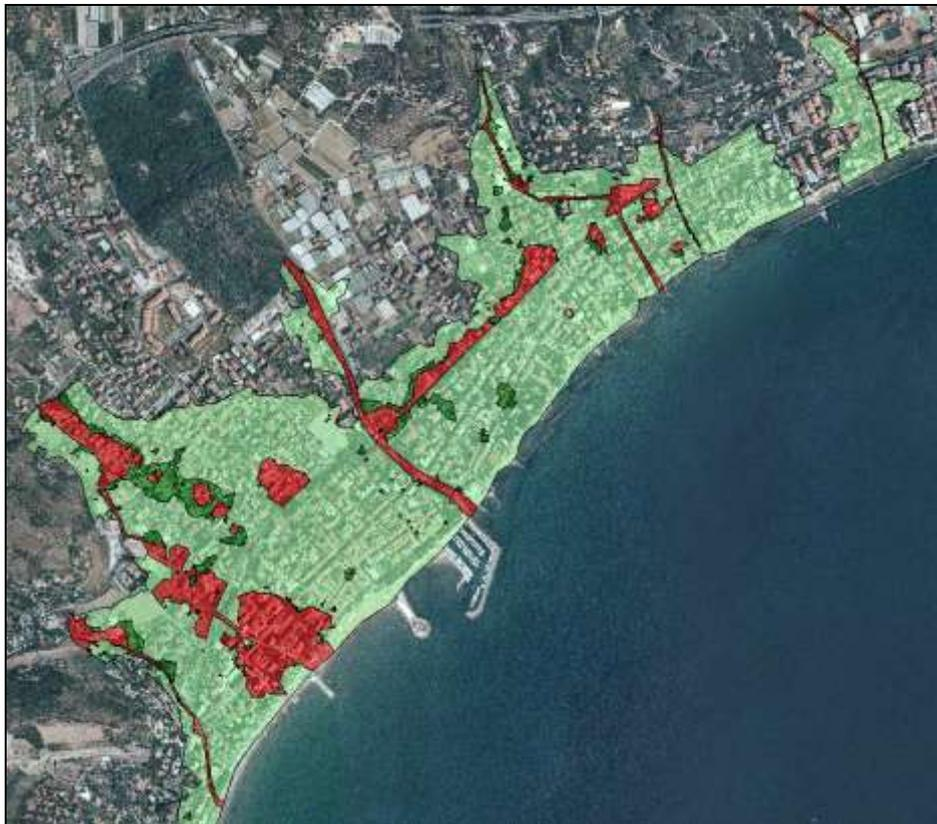
Figura BO Ambiti normativi con velocità interpolate considerando i blocchi (idrogramma  $Q_{max\_P}$ )
