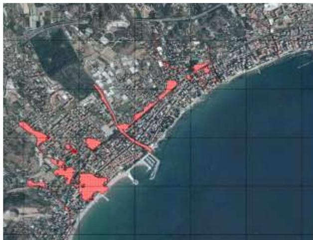
Figura AV Fascia A per porosità a zone (aree in rosa) e per porosità standard (aree in rosso), ricavate per idrogrammi Qmax\_P
