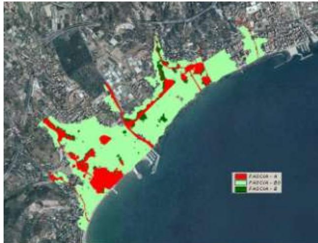
Figura BD Aree pericolose ottenute interpolando i valori delle velocità imponendo nel baricentro di ciascuno delle aree intercluse dagli edifici (blocchi) la velocità nulla.
