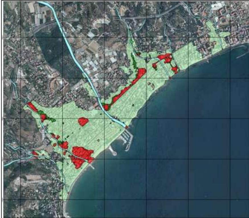
Figura BH Ambiti normativi (DGR 250/05) ottenuti sovrapponendo alle velocità interpolate con valori nulli (blocchi) le velocità delle sole strade da modello idraulico, per idrogrammi  $Q_{max\_V}$
