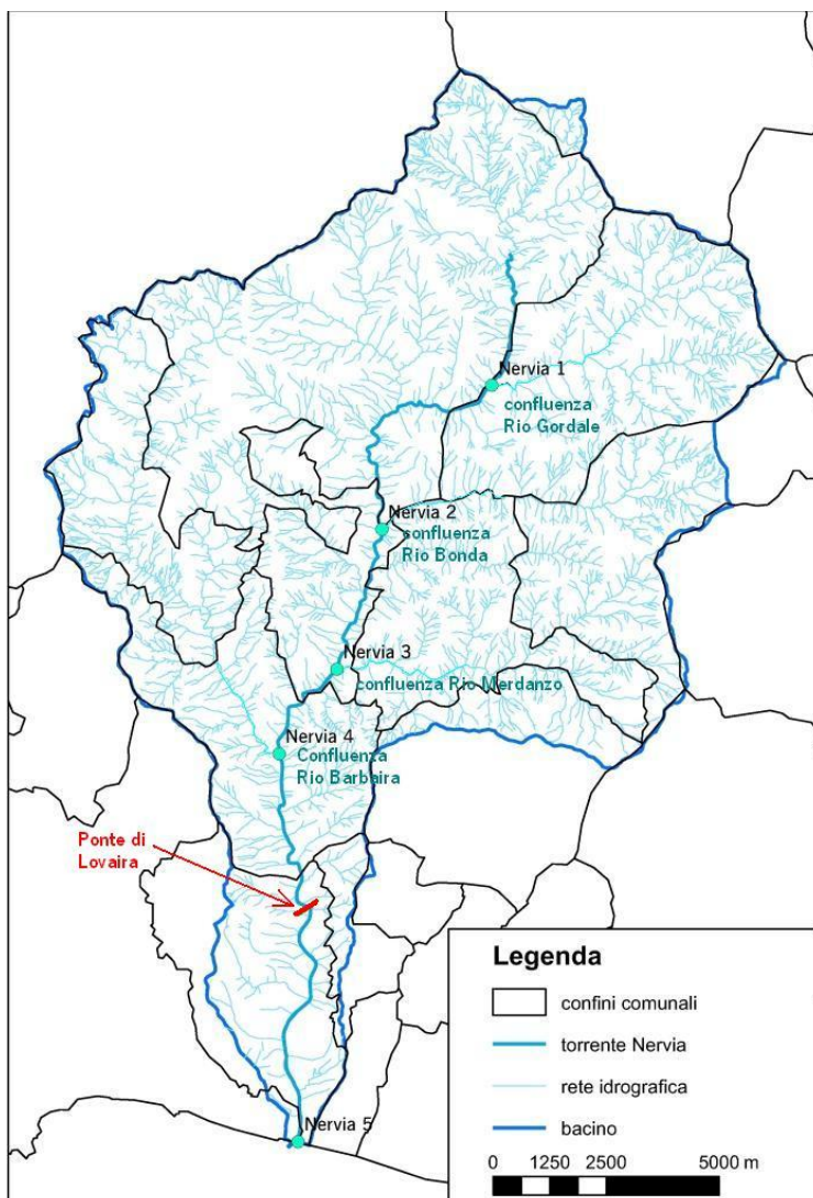
Figura 2.9 – Bacino del torrente Nervia con in evidenza le sezioni di chiusura alle quali si riferiscono i risultati idrologici e l'ubicazione della sezione intermedia a Ponte di Lovaira
