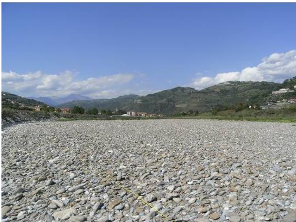
Figura 3.3 – Ampia barra laterale posta in sinistra idrografica all'altezza del Centro ESSE. La granulometria prevalente è costituita da ghiaia molto grossa, ma il sedimento è molto eterogeneo con grado di classazione molto basso e la curva granulometrica è asimmetrica verso il fine (fonte: Comuni di Ospedaletti – Bordighera, 2008).
