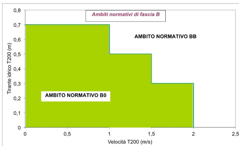
Soglie di pericolosità relativa in termini di tirante idrico locale  $h_{200}$  condizionato alla velocità locale della corrente  $v_{200}$  ai fini della definizione degli ambiti normativi in **fascia B**
