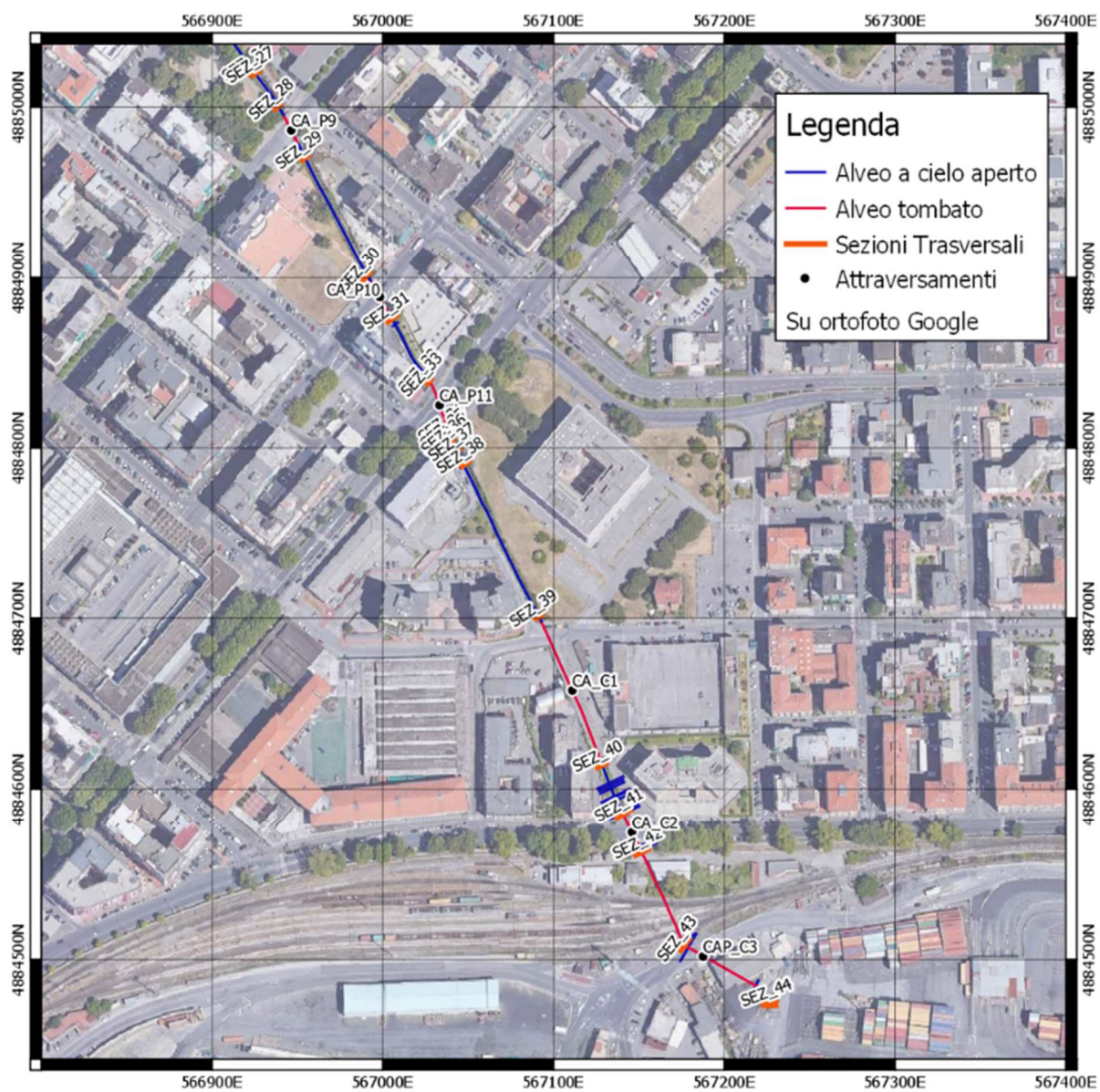
Figura 6 – Network del modello MIKE11 allestito per il Fosso Cappelletto, tratto di valle.
