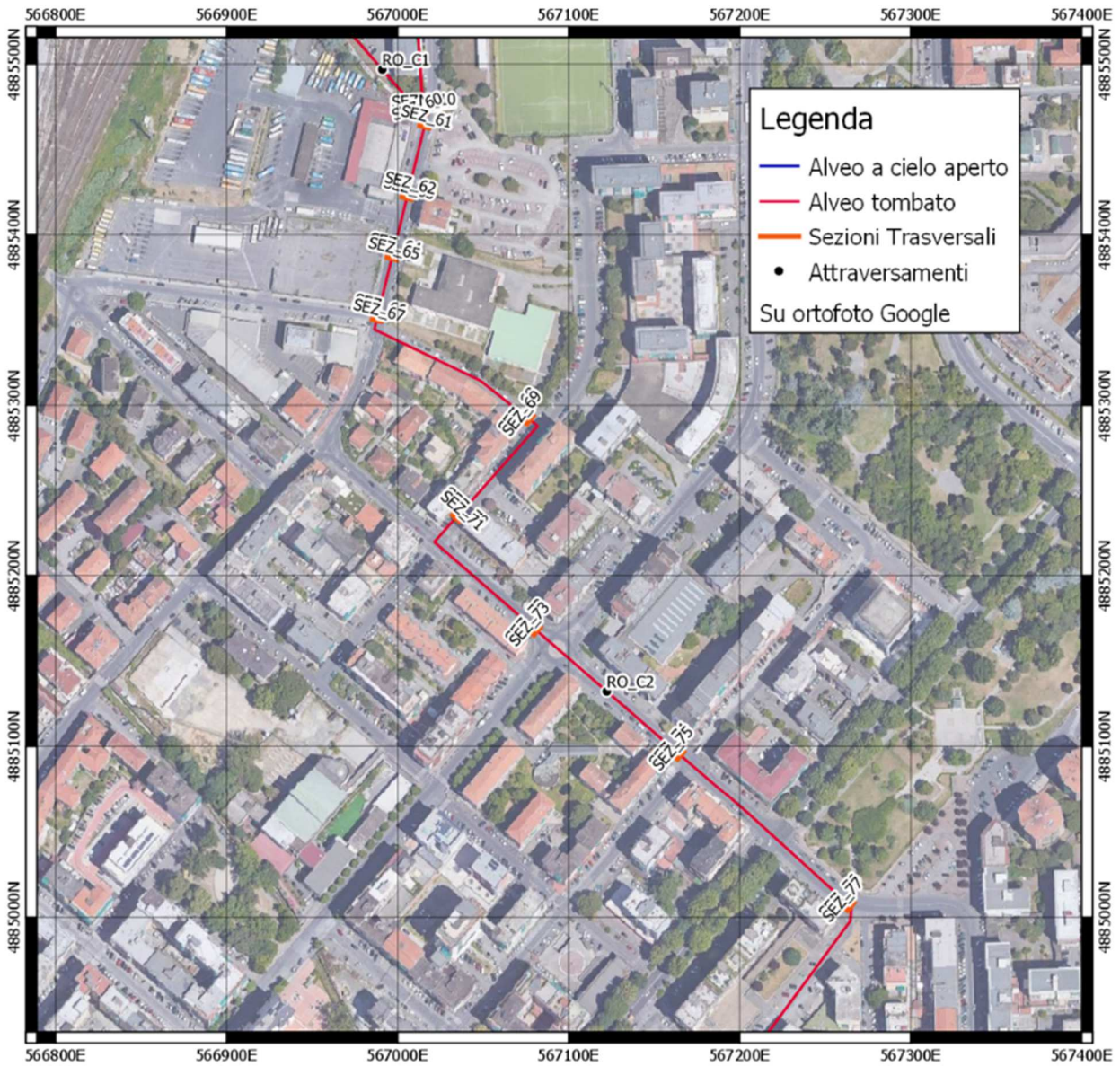
Figura 3 – Network del modello MIKE11 allestito per il tratto centrale del Fosso Rossano.
