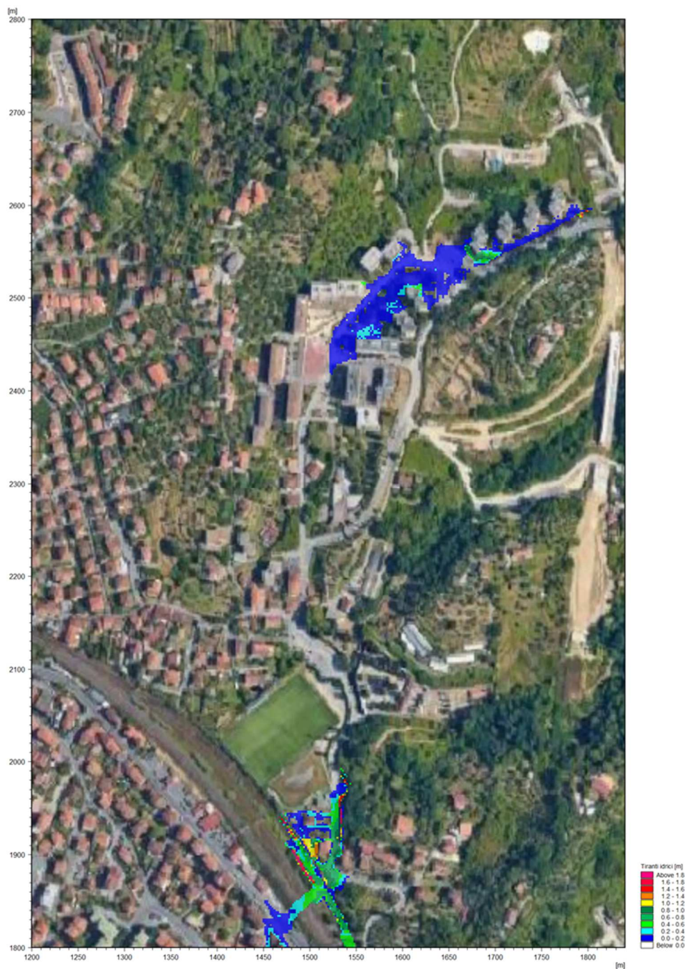
Figura 38 – Distribuzione delle altezze idriche rispetto al piano campagna alle ore 05:04 dell'evento di piena con tempo di ritorno di 50 anni (vedi idrogramma di Figura 13). L'area rappresentata è relativa al tratto a monte della ferrovia del Torrente Vecchia Dorgia.
