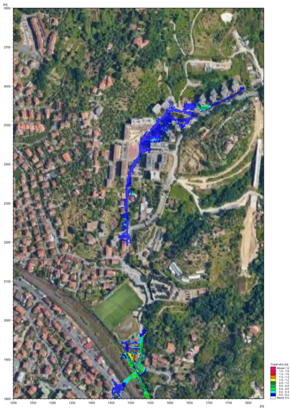
Figura 39 – Distribuzione delle altezze idriche rispetto al piano campagna alle ore 05:10 dell’evento di piena con tempo di ritorno di 50 anni (vedi idrogramma di Figura 13). L’area rappresentata è relativa al tratto a monte della ferrovia del Torrente Vecchia Dorgia.
