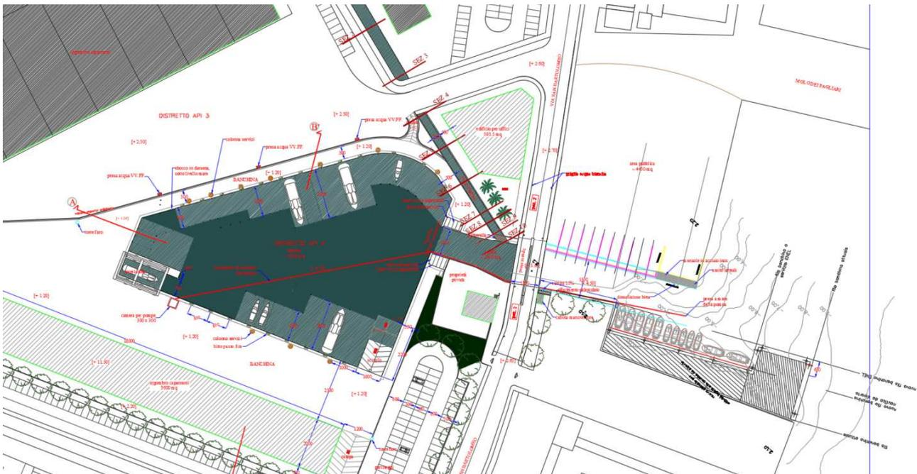
Figura 5 – Stralcio della planimetria di progetto della Darsena Pagliari fornita dall'Autorità Portuale e utilizzata per la costruzione della batimetria del modello 2D.
