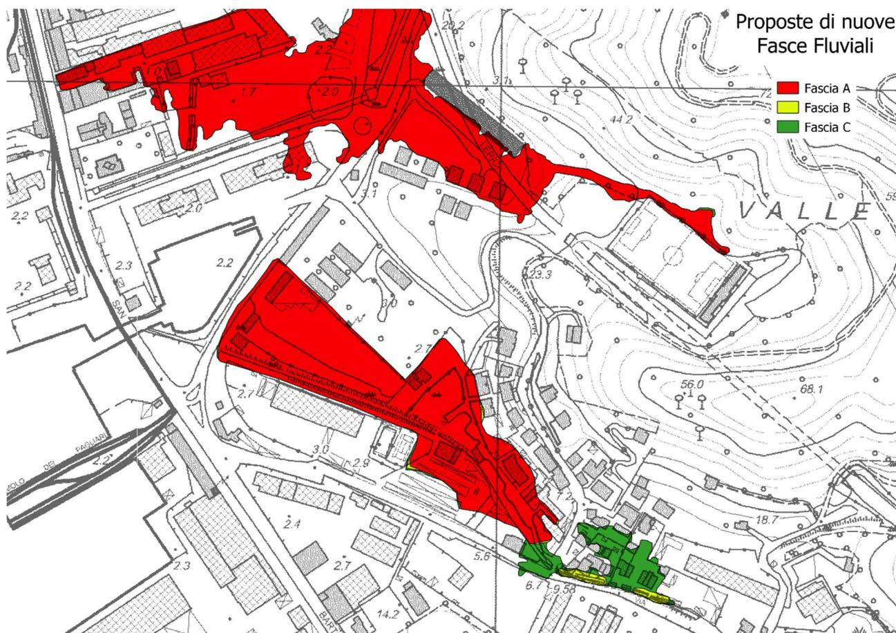
Figura 33 – Estensione delle nuove fasce A, B e C proposte per il torrente Pagliari e il rio di Valle Oscura.
