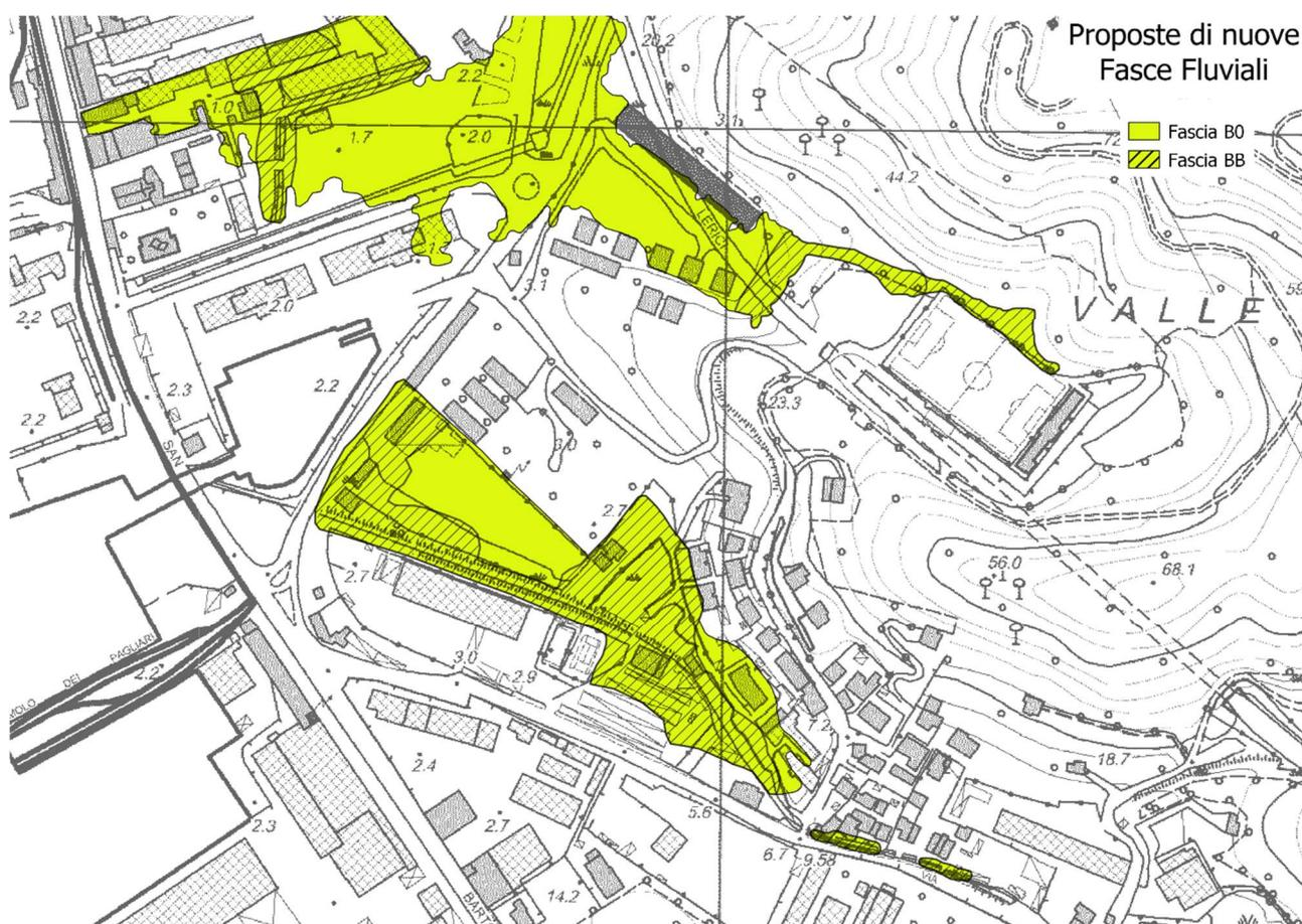
Figura 35 – Definizione delle aree B0 e BB all'interno della fascia B per il torrente Pagliari e il rio Valle Oscura.
