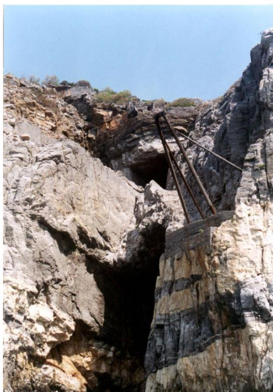
**Figura 46 - Vecchia cava di marmo Portoro con l'imbocco in corrispondenza della falesia della Palmaria. E' interessante la presenza della vecchia capra utilizzata per lizzare sulle chiatte i blocchi estratti.**
