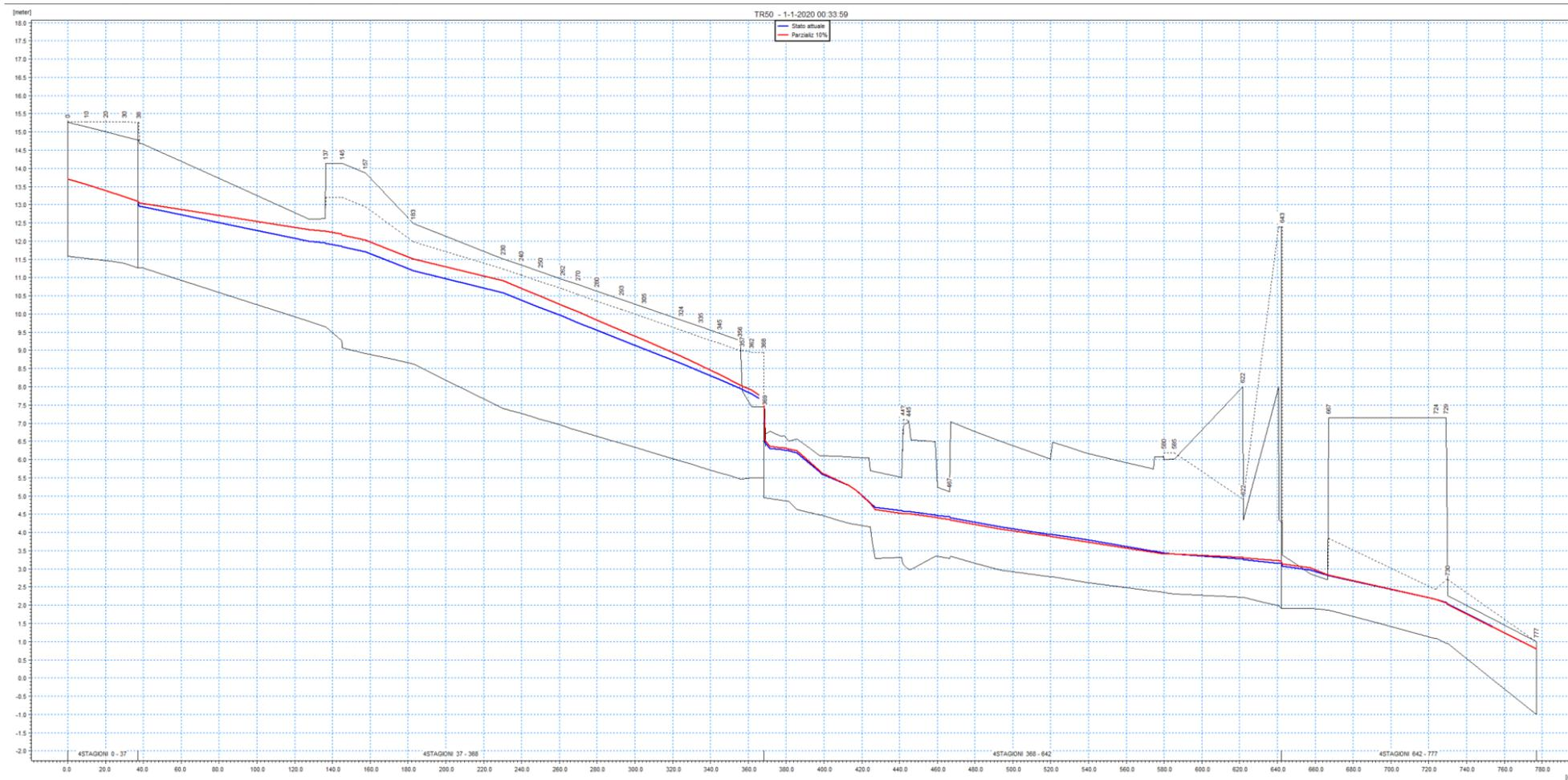
Figura 4.10 Confronto tra il profilo longitudinale dei livelli idrici in alveo in caso di scenario di stato attuale (linea blu) e scenario di parzializzazione delle sezioni (linea rossa) per l'evento di piena cinquantennale.
