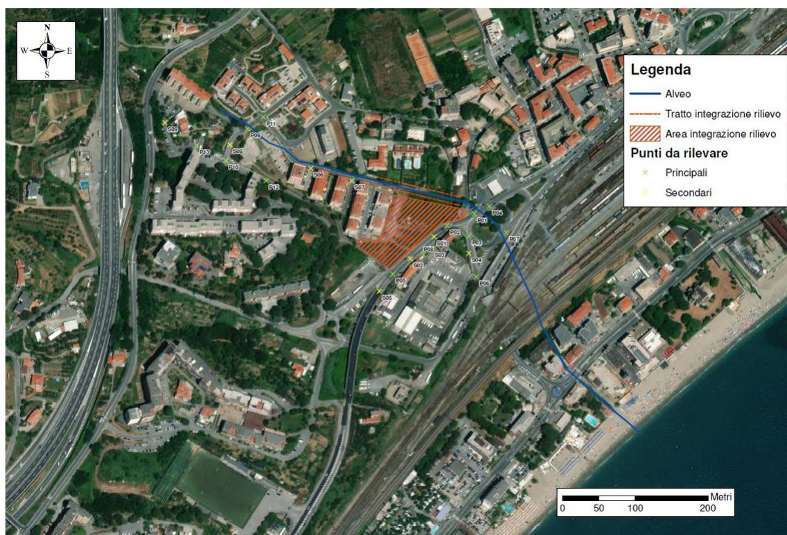
Figura 1.12 Piano di indagine finalizzato al rilievo topografico sul rio Quattro Stagioni e sul territorio limitrofo.
