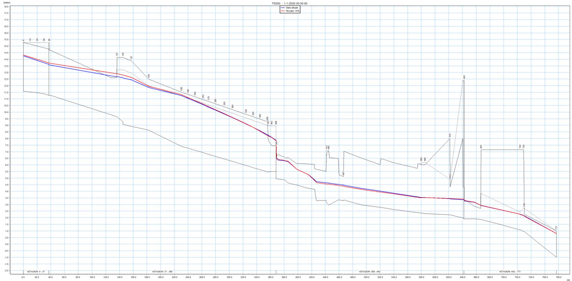
Figura 4.11 Confronto tra il profilo longitudinale dei livelli idrici in alveo in caso di scenario di stato attuale (linea blu) e scenario di parzializzazione delle sezioni (linea rossa) per l'evento di piena duecentennale.
