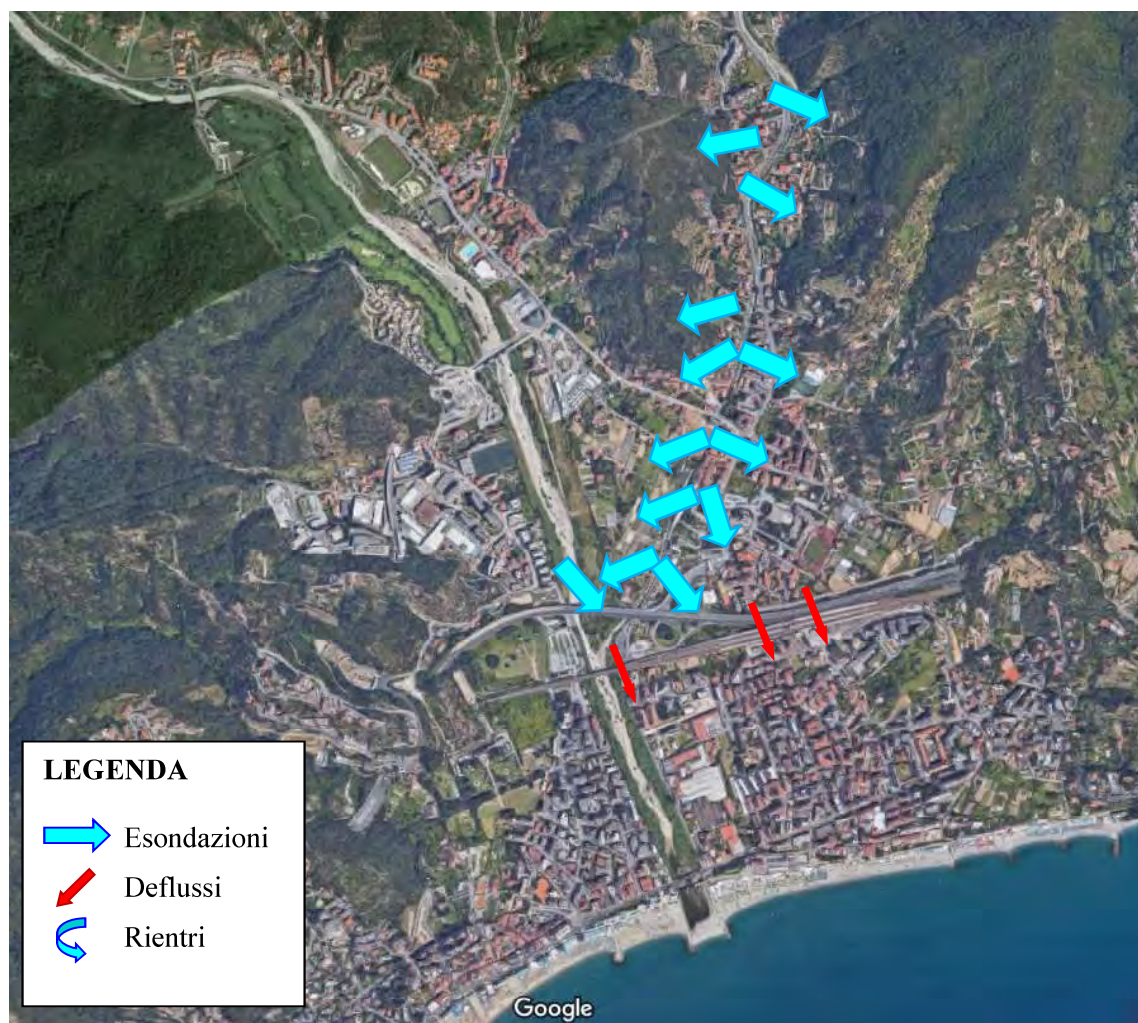
Figura 5.1: Planimetria con indicati i punti di esondazione e le via di deflusso principali
