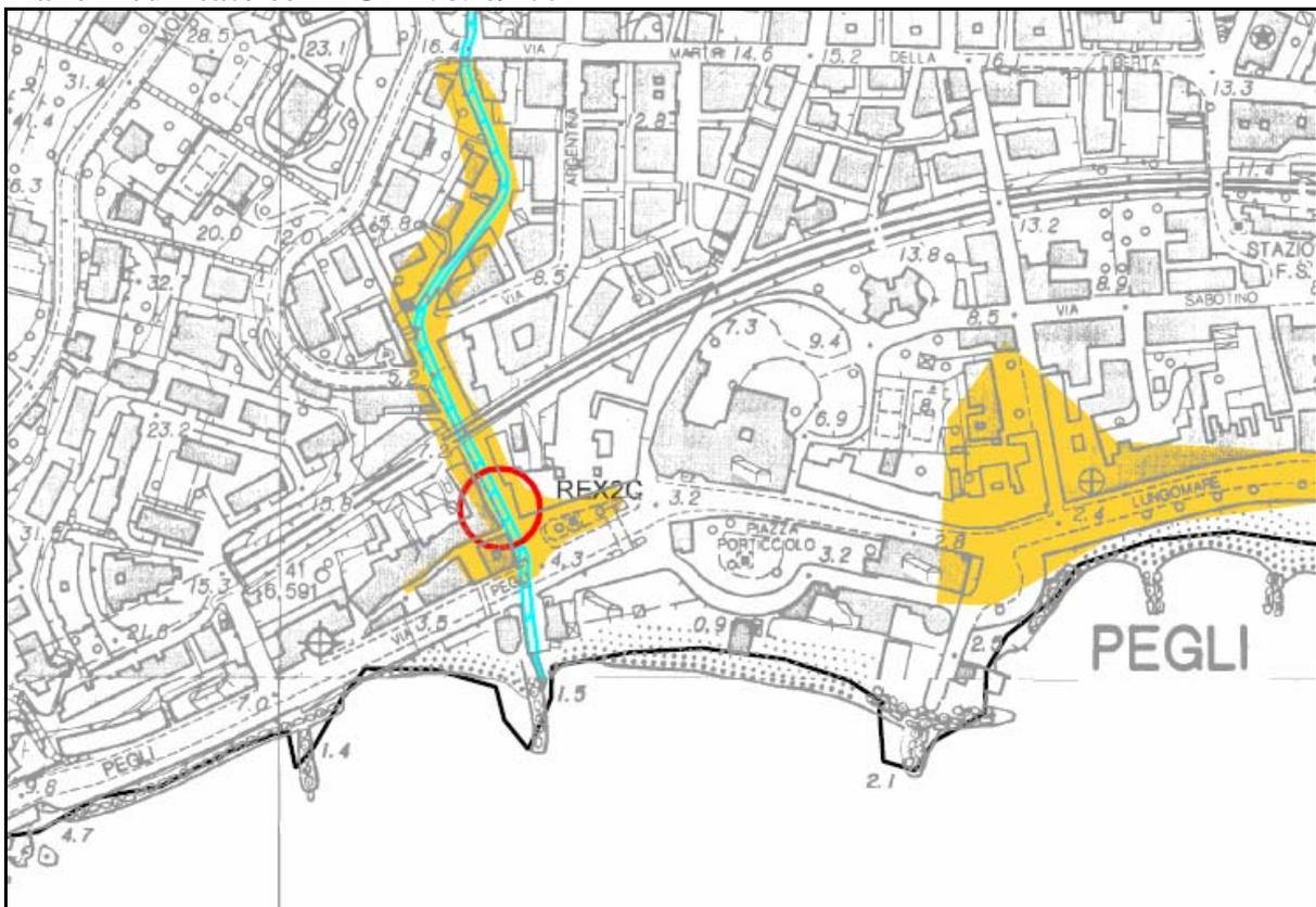
Per quanto riguarda lo sbocco della galleria, è stata eliminata una parte del terrapieno presente sulla sponda destra del t. Varenna e questo ha consentito l'apertura di un nuovo fornice sulla sponda destra del t. Varenna, condizione necessaria alla messa in funzione dello scolmatore (fine anno 2004-inizio 2005). Allo stato attuale (marzo 2007) lo scolmatore non risulta ancora in funzione.
