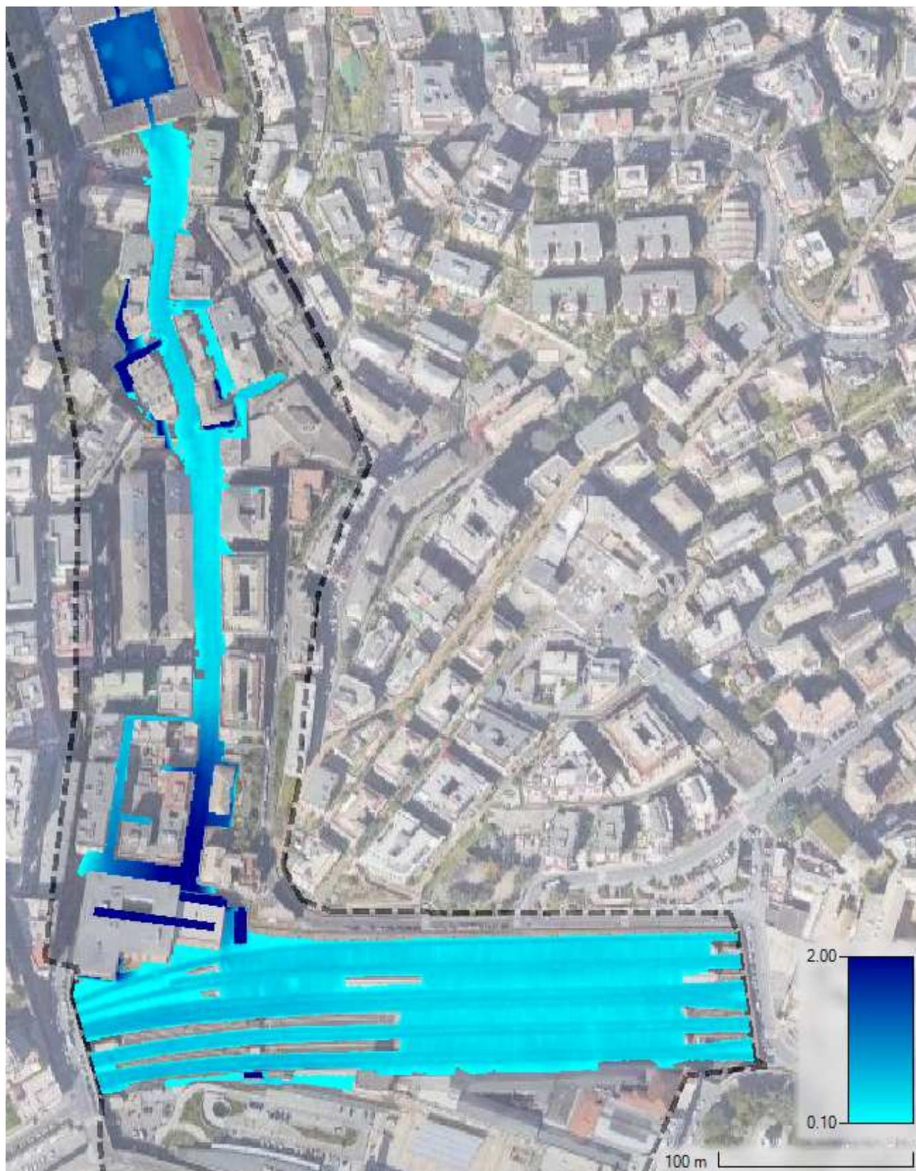
Figura 68 Tiranti d'acqua Tr-200 lungo via Lagaccio e all'interno della stazione Porta Principe
