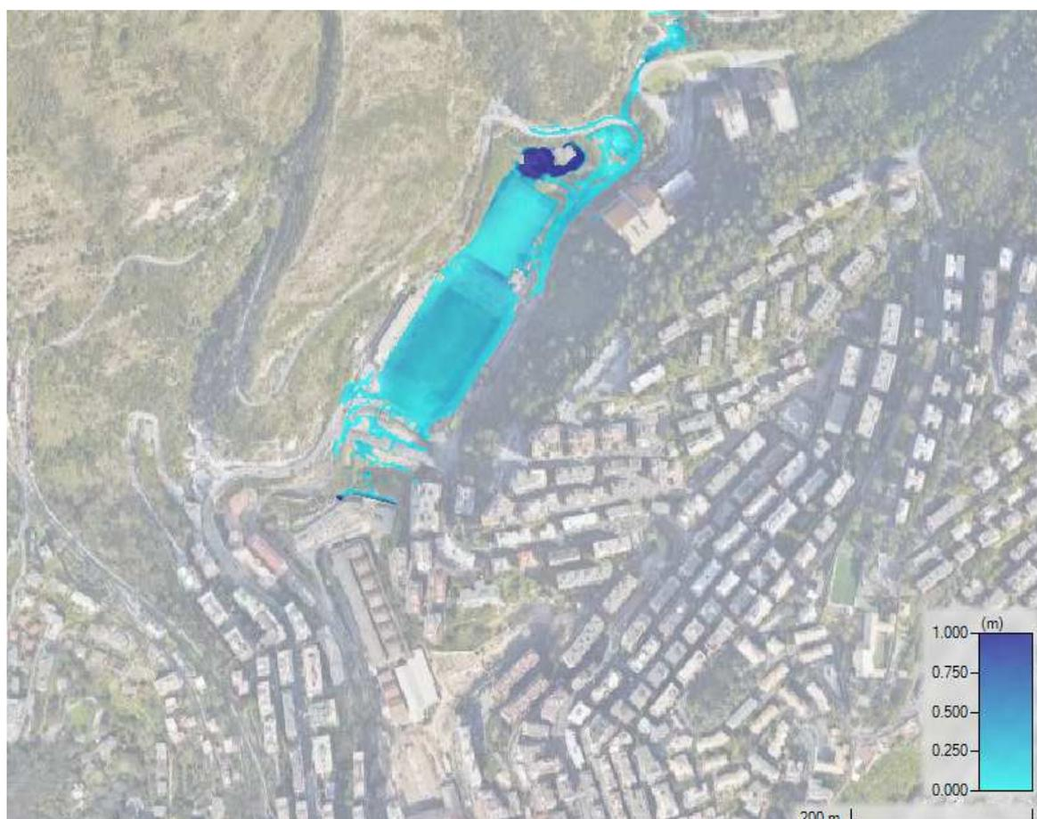
Figura 73: Scenario di mitigazione del rischio con unici allagamenti residuali T200 limitati alla parte di monte, e con area valle della ex-caserma fino allo sbocco priva di qualsiasi situazione di allagamento
